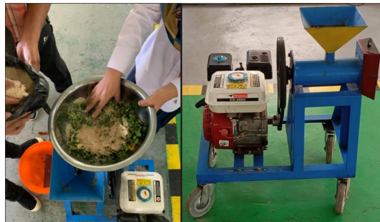
Gambar 2. Mesin pellet ikan dan proses pembuatan pellet ikan
